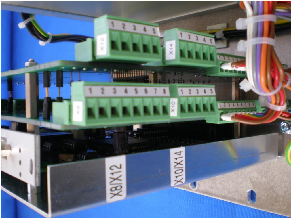
Die Ansteuerung der Einschaltung erfolgt über die Steckverbinder X8, X10, X12, X14 auf der Baugruppe IB1000 zum Frequenzumformer M300. Die Rückmeldung und die Lüfterspannung sind hier auch als Steckverbinder vorhanden. Die Lüfterspannung wird nicht mehr benützt, die Klemmstelle bleibt vorhanden.
