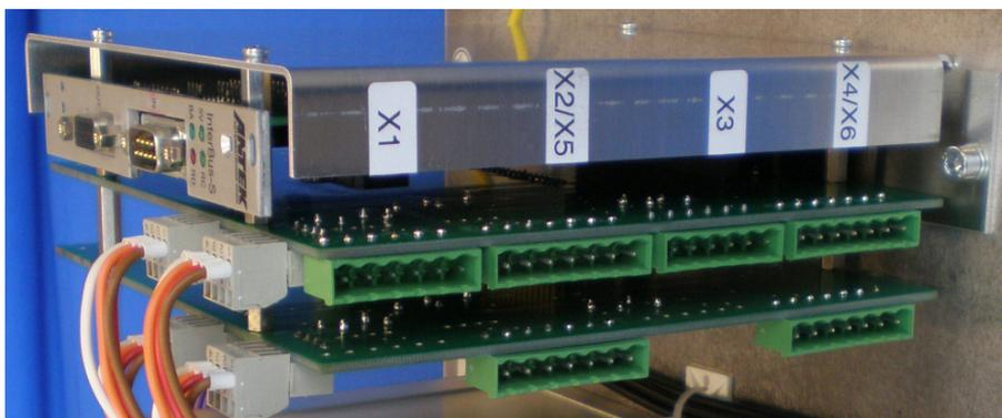
Die Baugruppe IB1000-01 mit der Adaptereinheit A519 dient zur Kontaktierung der Ansteuerungssignale und Spannungsversorgung extern. Die Ansteuerung der Frequenzumformer (FU) erfolgt über die Interbusbaugruppe A422 mit der Adaptereinheit A519 zum FU M300.
